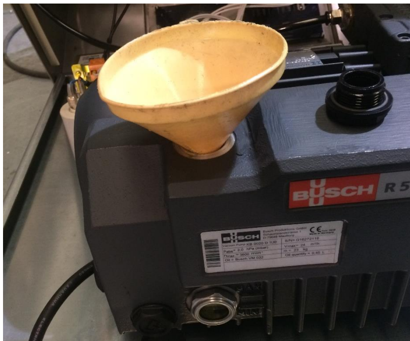
Abbildung 7. Öleinfülldeckel entfernen und frisches Öl einfüllen
