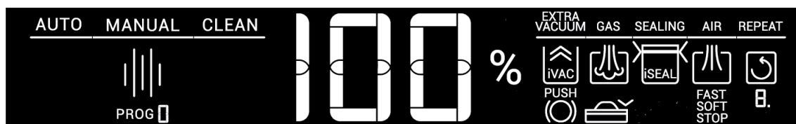
Abbildung 7. Bearbeiten der Verpackungsparameter im manuellen Betrieb
