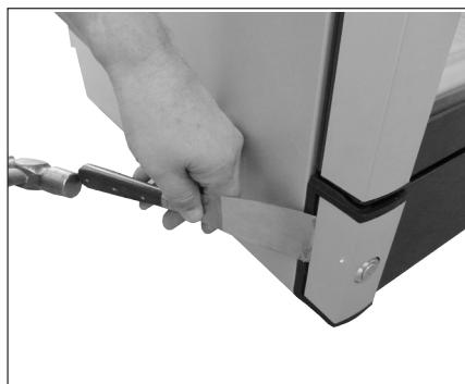
3. Снимите крышку с помощью соответствующего инструмента и молотка
