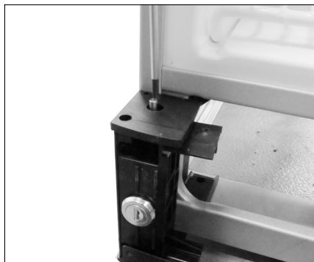
13. Svitare il perno di bloccaggio.
