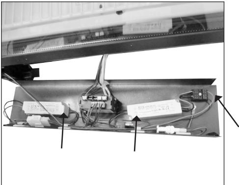
18. Die Kabel der Türbeleuchtung in die Kabelhalter einklicken und wieder in der Klemme anbringen.
