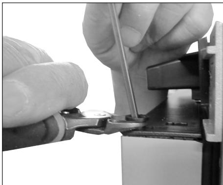
7. Удалите втулку и дверной механизм с помощью клемм.
