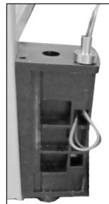
14. Die Kabel der Tür in den Türzapfen schieben und hindurch ziehen.
