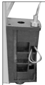
14. Протолкните провода от двери вниз к дверному штифту и протяните через дверной штифт.
