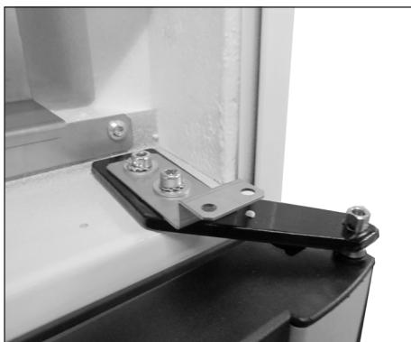
6. Desatornille el soporte del dosel y la bisagra de la puerta en el lado derecho.
