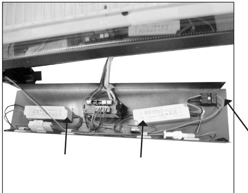
18. Enganche los alambres de la luz de la puerta en los retenedores de alambre e instálelos en el conector.
