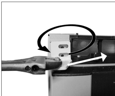
17. Plaats het linker scharnier boven op de deursluiting.
