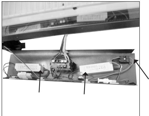
18. Защелкните провода к дверному освещению на фиксаторы-держатели проводов и установите их в разъем.
