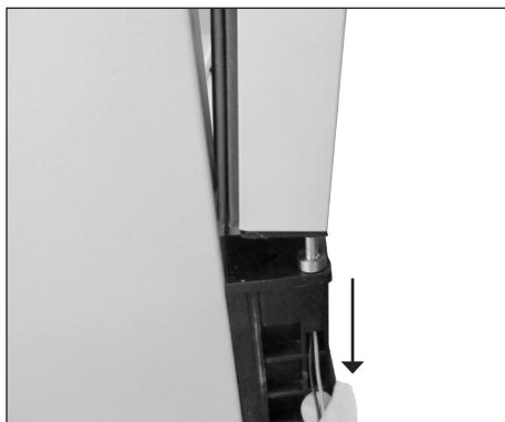
15. Установите дверь на верхней части дверного штифта и одновременно осторожно натяните провод вниз так, чтобы он не был зажат.
