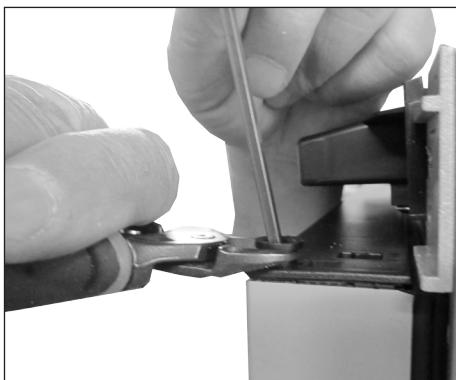
7. Retirez le coussinet et le fermoir de porte en utilisant des pinces.
