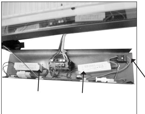
18. Insérez les fils de l'éclairage de porte dans les fixations de fils et dans le connecteur.
