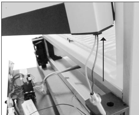
8. Levante la puerta. Los alambres de la puerta se halan juntos con el pasador de la puerta.
