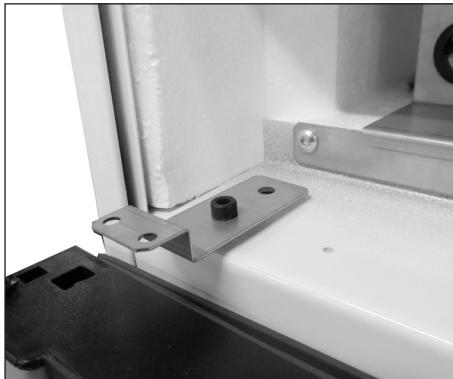
c. Draai de beugel aan de linkerzijde los.
