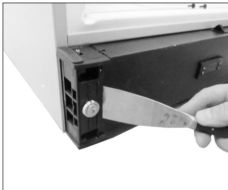
4. Die untere Bedienungstafel mit einem geeigneten Werkzeug entfernen.
