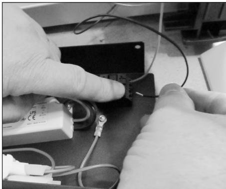
5. Retire los alambres negro y rojo del conector presionando los ganchos de sujeción.
