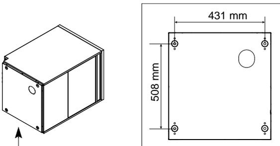
3. Die Geschirrspülmaschine so auf die Trägerplatte stellen, dass die soeben ausgeführten Bohrungen an den Aussparungen für die Füße an der Geräteunterseite ausgerichtet sind (siehe folgende Abbildung).
