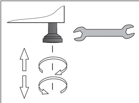
Es ist **absolut notwendig**, das Gerät nach der Positionierung zu nivellieren.
