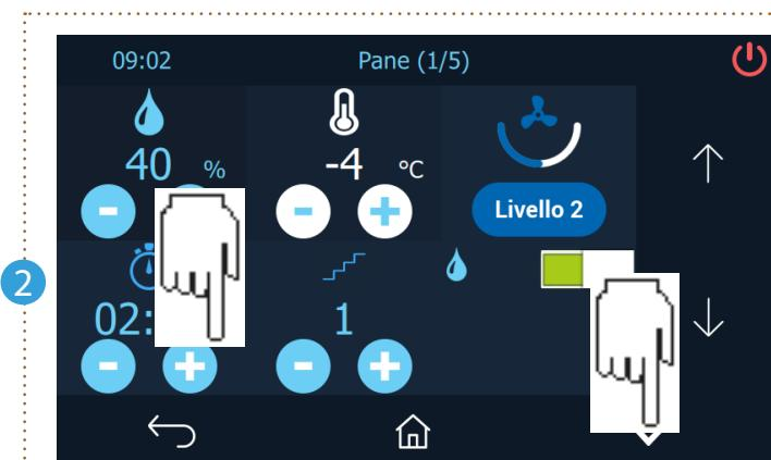
Die Parameter des Sets (Temperatur, Feuchtigkeit, Gebläsegeschwindigkeit, Anzahl der Schritte, Dauer, Anzahl der Schritte, Dauer) permanent mit den Tasten und ändern.
